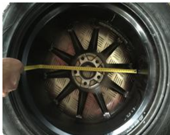
Рис.1 Пример измерения вручную диаметра da2 колеса в режимах ALS
